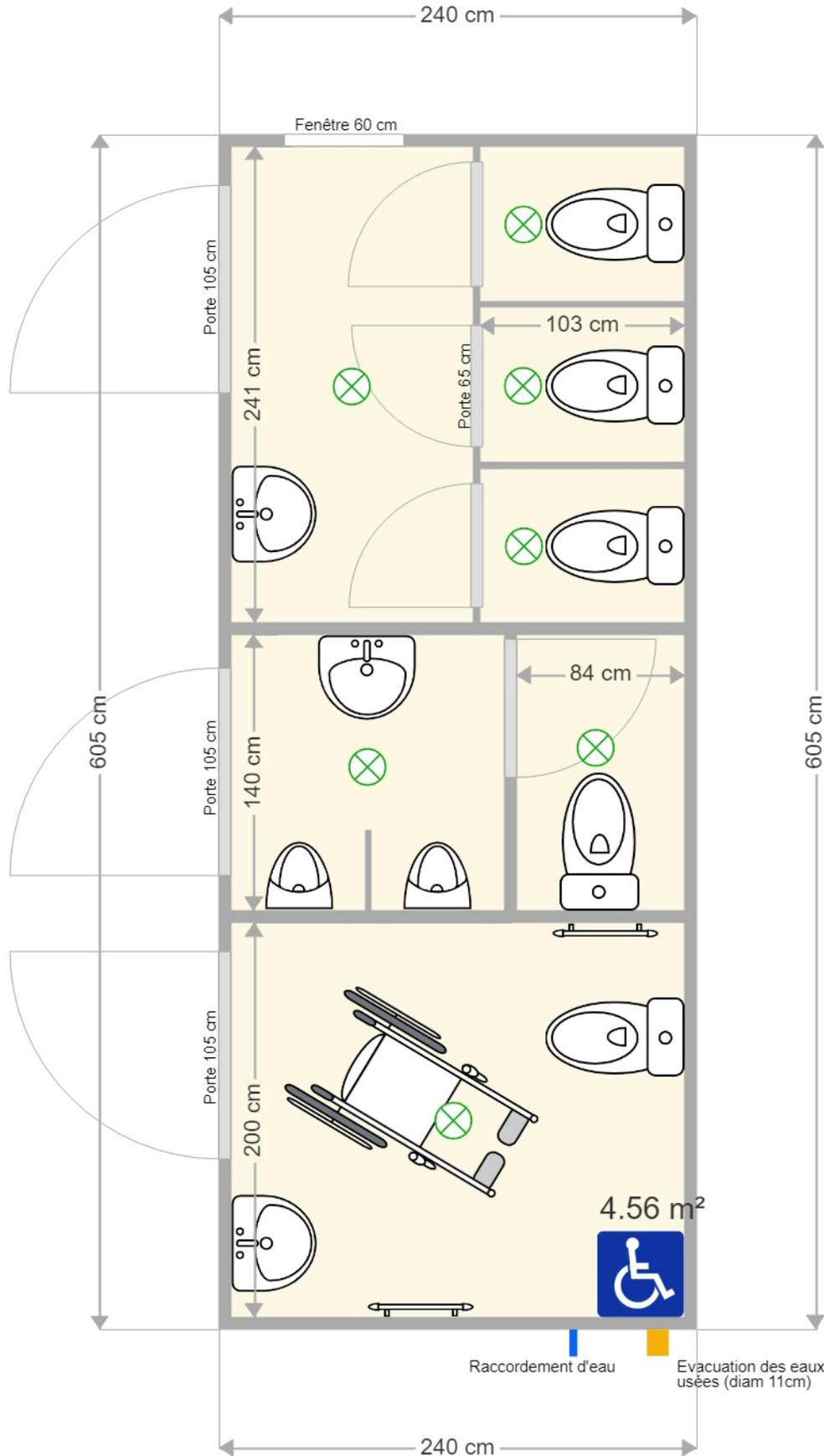
Module sanitaire avec 5 WC dont un PMR, 2 urinoirs, 3 lavabos, équipé de miroirs, portes manteaux, porte savon, extracteur d'air et chauffage.
